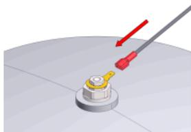
Anschlussende der Anschlussleitung mit Titananode verbinden:
