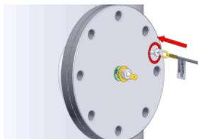
Anschlussende mit Hinweissfahne "Masseanschluss Behälter" (Behälter = Speicherwassererwärmer) mit dem Metall des Speicherwassererwärmers elektrisch leitend verbinden:
