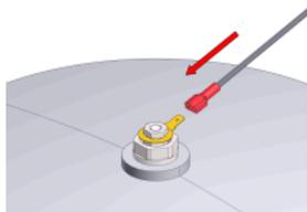
Anschlussende der Anschlussleitung mit Titananode verbinden:
