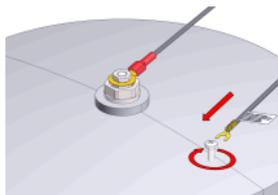
Anschlussende mit Hinweisschraube "Masseanschluss Behälter" (Behälter = Speicherwassererwärmer) mit dem Metall des Speicherwassererwärmers elektrisch leitend verbinden:
