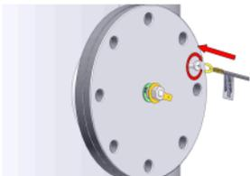
Anschlussende mit Hinweisfahne "Masseanschluss Behälter" (Behälter = Speicherwassererwärmer) mit dem Metall des Speicherwassererwärmers elektrisch leitend verbinden:
