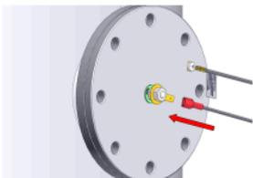
Anoden-Anschlussende der Anschlussleitung mit Titananode verbinden:
