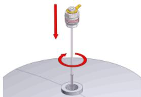
Titananode mit Verschlusschraube druckdicht in Gewindemuffe am Speicherwassererwärmer einschrauben.
